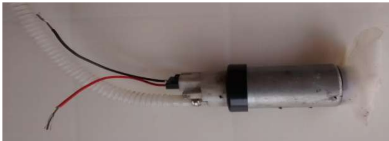
Figura 7 – bomba de combustível usada para bombear o fluido de corte.
