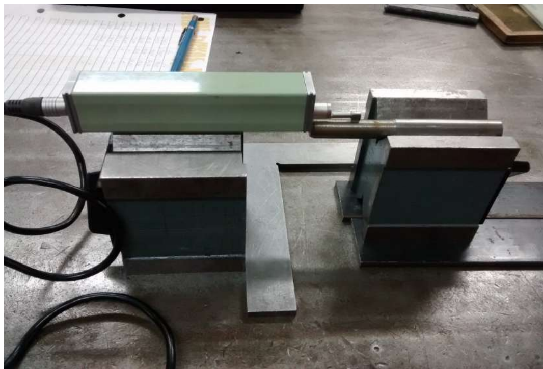
Figura 8 - Análise da rugosidade superficial com rugosímetro SJ-201.
