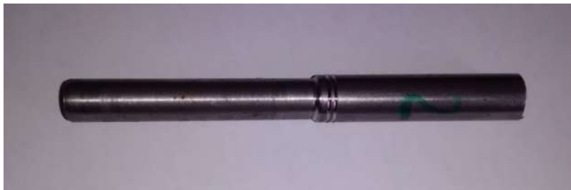
Figura 6 – Corpo de prova em aço SAE 1045.
